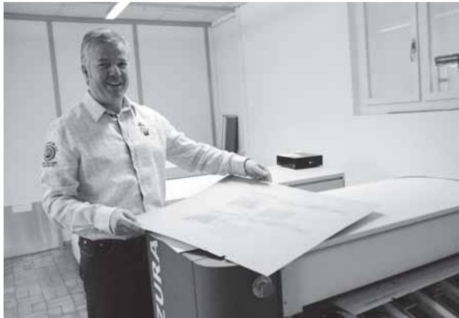
Die Druckplattenherstellung erfolgt ohne jede Chemie.
