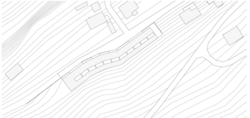
*Das mehrfach geknickte, zweigeschossige Volumen, mit seinen sechs Wohneinheiten, folgt der Topografie entlang des Hanges.*
