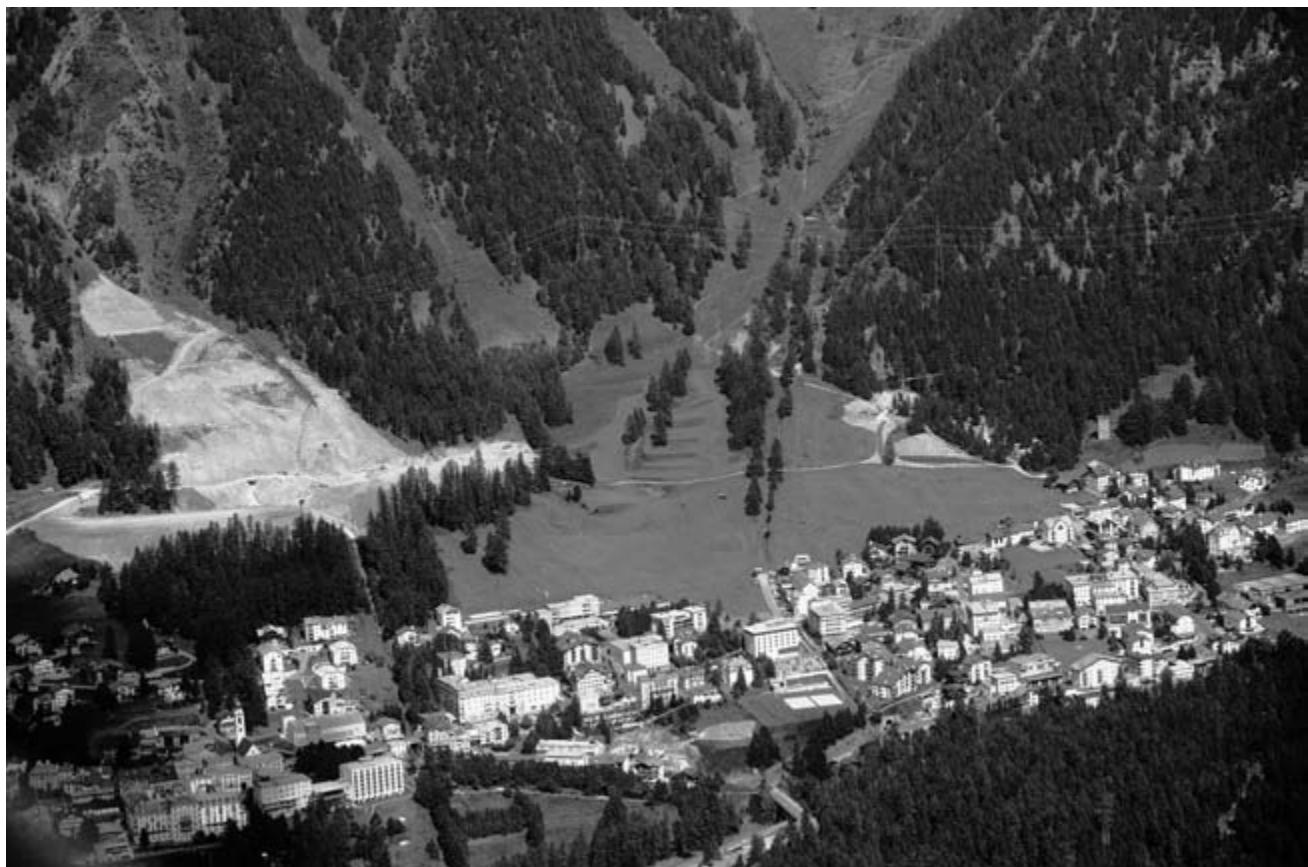
Pontresina hat über dem Dorf einen Schutzwall errichten lassen, der gegen Lawinen und Steinschlag schützen soll, eine präventive Massnahme angesichts des schwindenden Permafrosts
