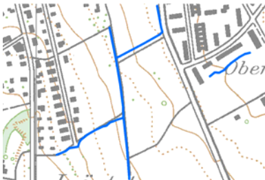
Drenaggio a cielo aperto o ripristino di ruscelli in caso di ampliamento di insediamenti
