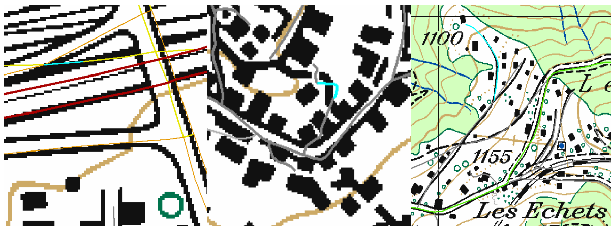
Abbildung 7: Beispiel Autobahnauffahrt FRC \geq 2 und Speed = 100 und Beispiel FRC \geq 2 und Speed = 100 ohne Autobahnnähe 7 , türkis gefärbt
