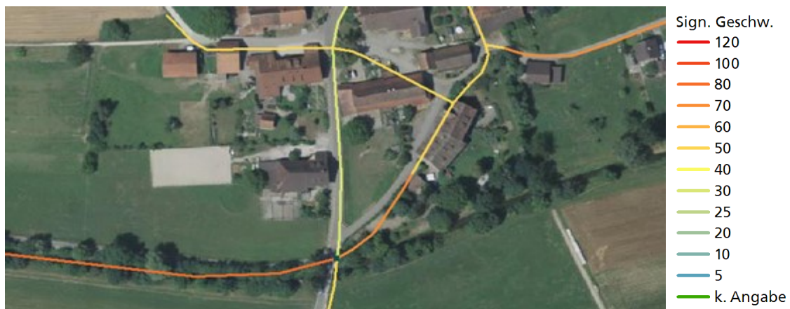
Abbildung 11: Differenz 40km/h aufgrund des Wechsels von ausserorts zu innerorts
