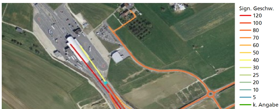
Abbildung 12: Differenz 60km/h aufgrund des Zolls
