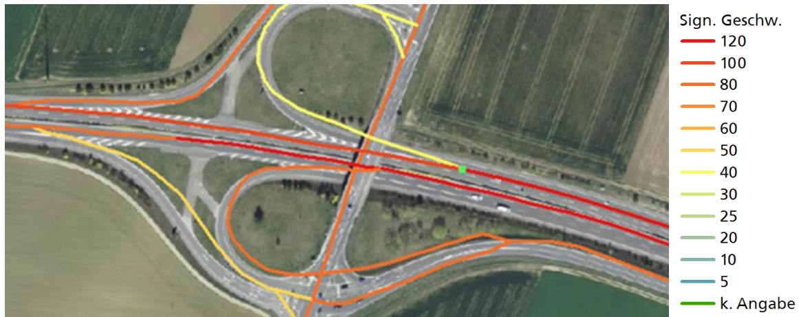
Abbildung 10: Differenz 80km/h aufgrund einer Ausfahrt in einer Kurve (40km/h) anknüpfend an die Autobahn (120km/h).
