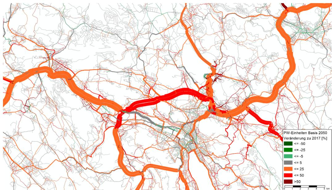
Abbildung 94: Entwicklung PW-Einheiten 2017-2050 – Szenario BASIS – Raum Zürich
