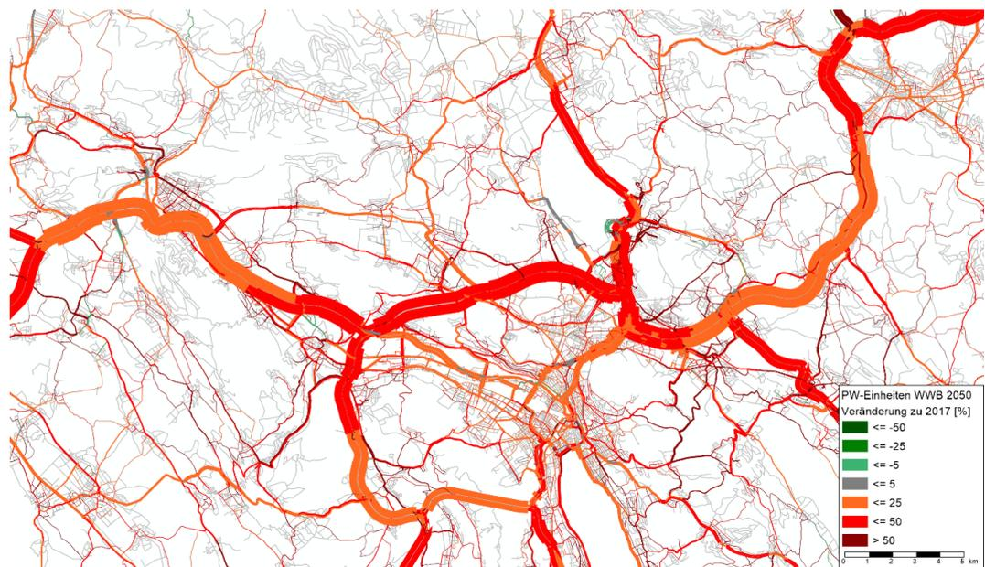
Abbildung 66: Entwicklung PW-Einheiten 2017-2050 – Szenario WWB – Raum Zürich
