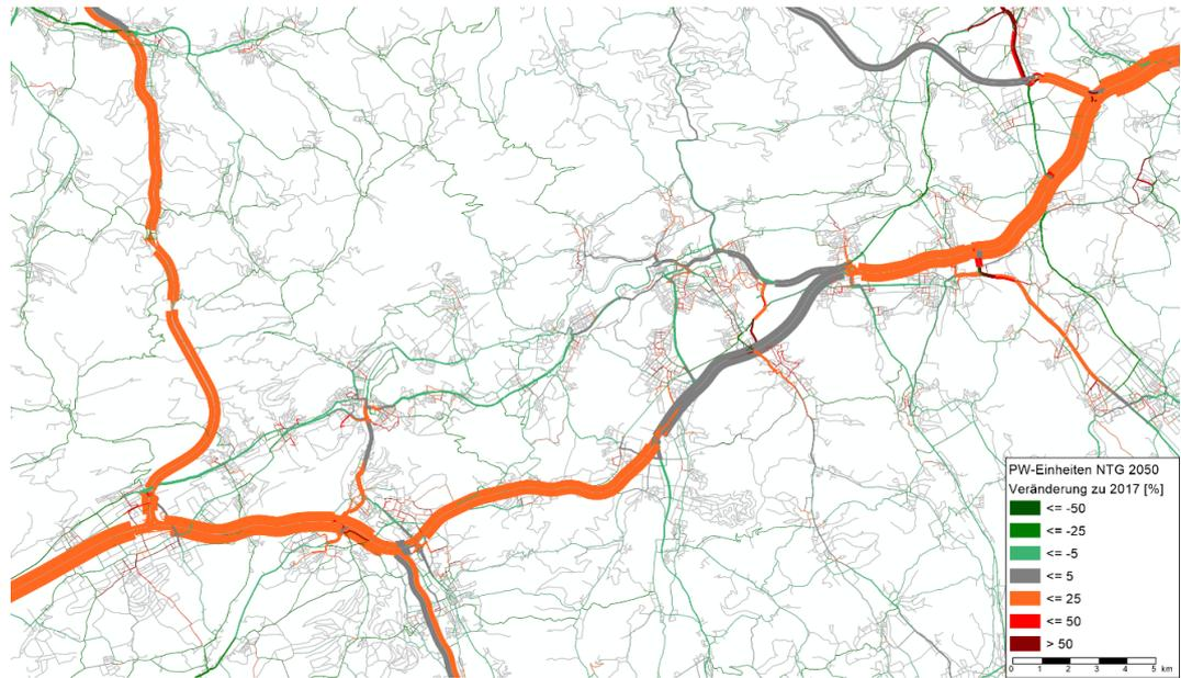
Abbildung 123: Entwicklung PW-Einheiten 2017-2050 – Szenario NTG – Raum Aarau & Olten
