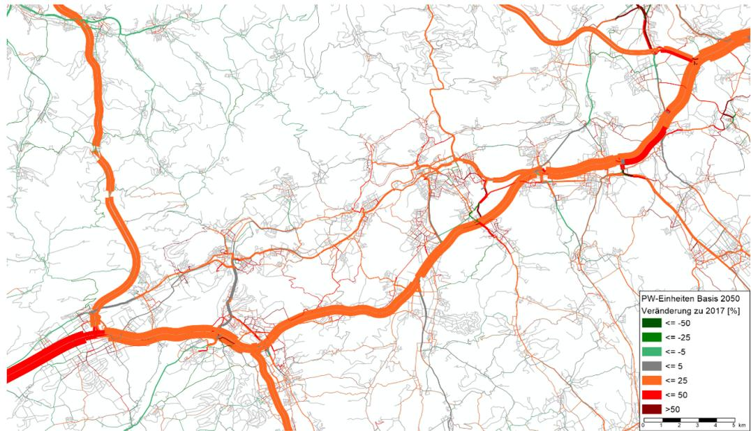
Abbildung 95: Entwicklung PW-Einheiten 2017-2050 – Szenario BASIS – Raum Aarau & Olten
