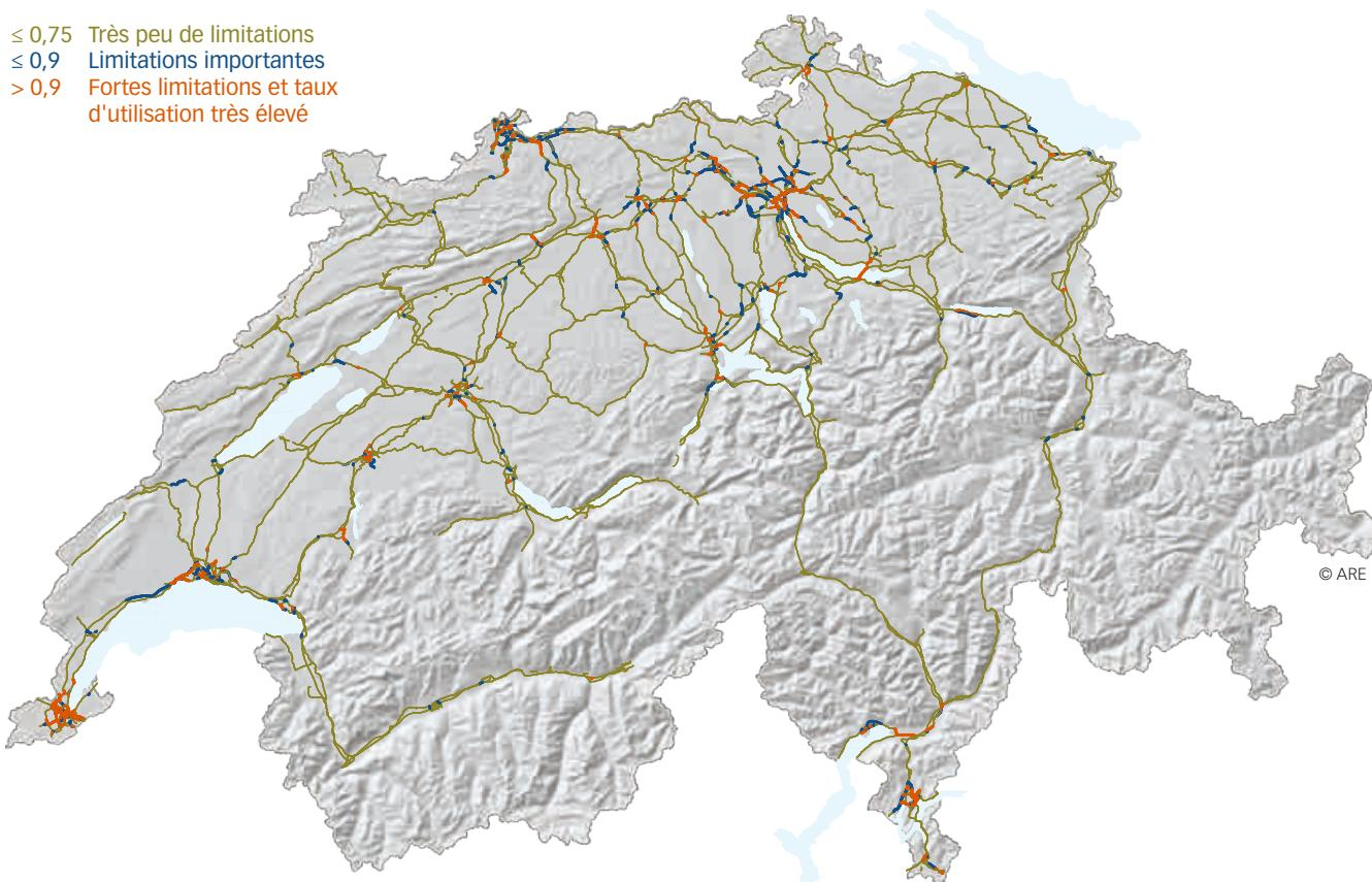
Scénario de référence: taux d'utilisation (véhicules/capacités) du réseau de RGD et de RGC en 2040
